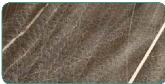
Рисунок 2-A: Обратите внимание на вихревые следы, оставшиеся после обработки оранжевыми пластинами (30 Grit).
